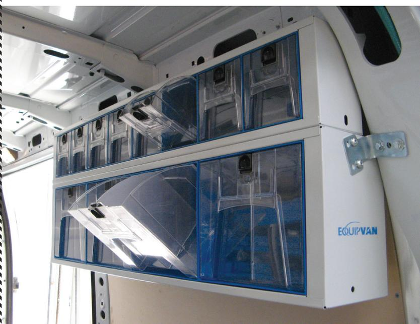
Equipvan MA. Les armoires à tiroirs transparents permettent de ranger le matériel correctement, et offrent la possibilité de contrôler visuellement leur contenu.
