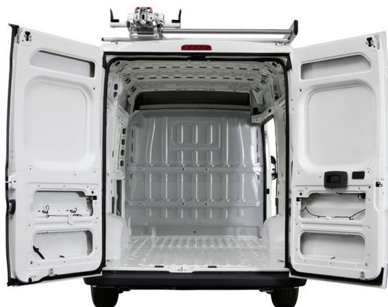
La carrosserie des fourgons utilitaires est réalisée en tôle acier laquée d'une épaisseur d'environ 0.7 à 0.8 mm pour la plupart des véhicules sur le marché.
